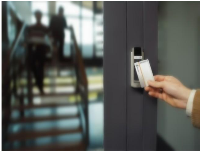
Een lezer bestaat uit kaartlezer en een deurvergrendelmechanisme
